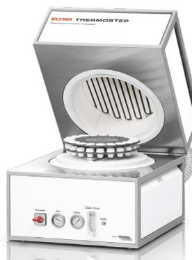
Mit dem neuen System lassen sich im Vergleich zum vorhandenen Messgerät mehrere Proben (bis zu 19 Proben) gleichzeitig prüfen, wodurch die Effizienz hinsichtlich Zeit und Ressourcen deutlich gesteigert wird und die Auftragsabarbeitung leichter steuerbar ist. Zum Vergleich: bisher kann alle drei Stunden eine einzelne Probe in das Gerät eingelegt und gemessen werden. Bei Messung von beispielsweise 15 Proben gleichzeitig steigt die Anzahl von 3 auf 45 Proben/Tag.
