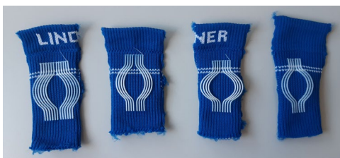
Dehnungsversteifende Strukturen: 3D-gedruckt an der Ruprecht-Karls-Universität Heidelberg
