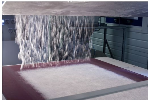
Erstellung einer Meltblown-Schicht am STFI
