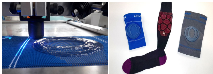
3D-Druck mit simultaner UV-Vernetzung (l.), Projektdemonstratoren (r.)
