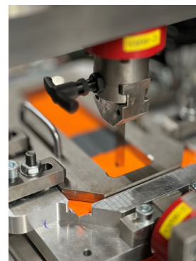
Nahaufnahme beim Durchstechen der Testklinge
