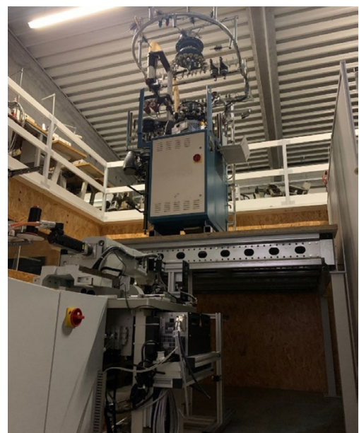
Abbildung 14: Umsetzung der Fertigungszelle auf einer Grundfläche von zwei Paletten, bestehend aus Rundstrickmodul, einer Aufziehvorrichtung, dem Transportsystem als 3-Achs-Portal, dem Prüf- und Ausrichtmodul sowie dem kombinierten Druck- und Nähmodul, Quelle: ORANGE/Pfeil
