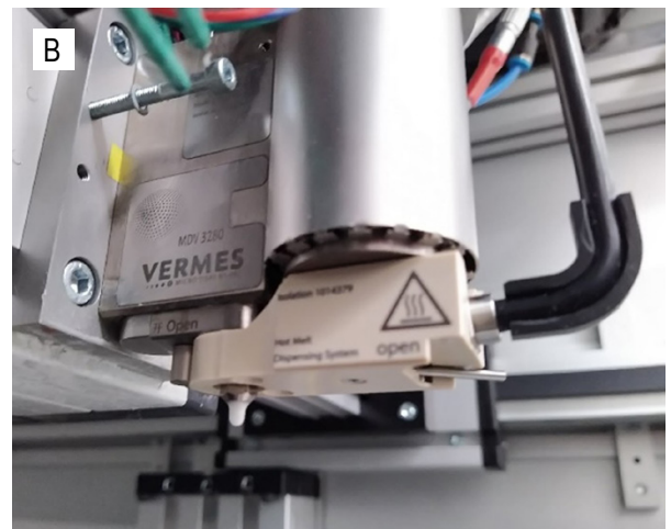
Abbildung 9: Jetventil in einem Versuchsaufbau A bei erfolglosem Test des LDPE Abifor 1020; keine Tropfenbildung und Tropfenablösung im Versuchsaufbau B, Quelle: STFI
