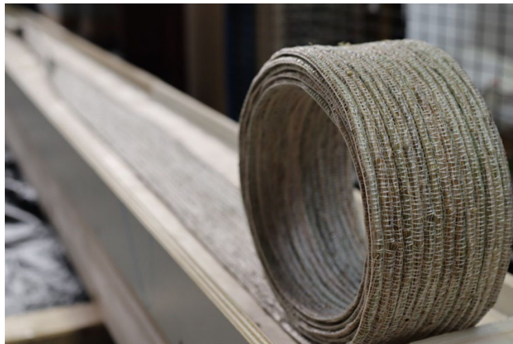
Leichtbau-Demonstrator aus Hanfbast im Holz-Beton-Bauwerk Quelle: HTWK Leipzig
