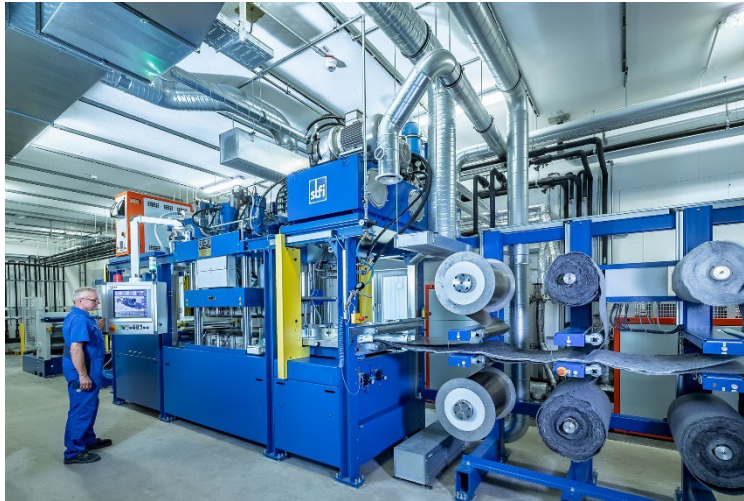
Intervallheißpresse bietet neuesten Möglichkeiten zur kontinuierlichen Herstellung von Organoblechen Quelle: STFI / Dirk Hanus
