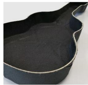
Abbildung 1: Definierte Faseranhäufung für Naturfaserhalbzeuge ©STFI
