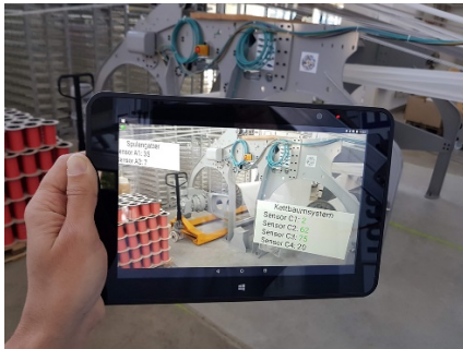
Links: Assistenzsystem mit markerbasierter Augmented Reality zur Visualisierung von Maschinendaten.
