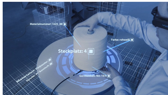
Rechts: Datenbrille zur Bereitstellung zusätzlicher Prozessinformationen.
