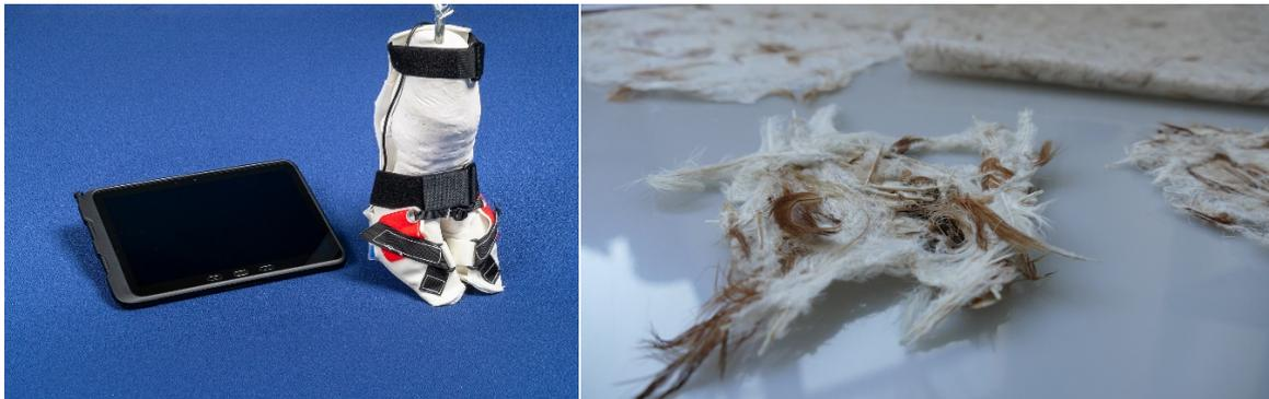
*Links: Im Vorhaben KlauSens wurde ein mobiles und robustes Sensorsystem zur Messung der Druckbelastungen unter den Klauen von Milchkühen im Laufstall entwickelt. Im Bild: ein erster Demonstrator des sogenannten Klauenschuhs (Foto: STFI/D. Hanus).*
