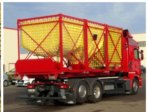
Prüfung Zugfestigkeit Netzprüfstand, Konfektion modularer Verbundkonstruktion, Funktionsmuster mobiles Silos auf Abroller
