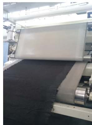
Spunlace-Anlage im STFI (li.) & wasserstrahlverfestigter Carbonfaservliesstoff (re.)
