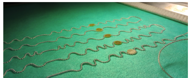
RFID-Funktionalisierung von OP-Tüchern
