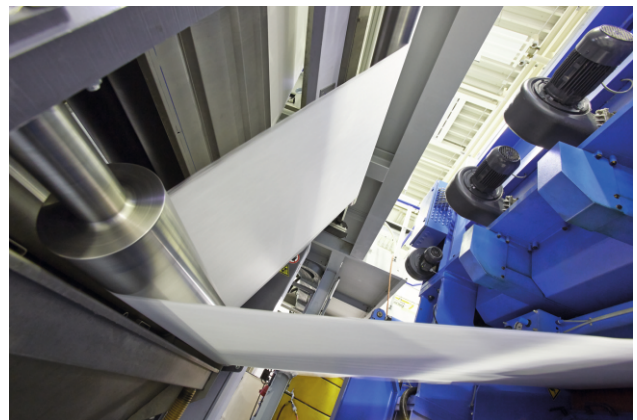
Spinnvliesanlage Reicofil®4 am STFI
