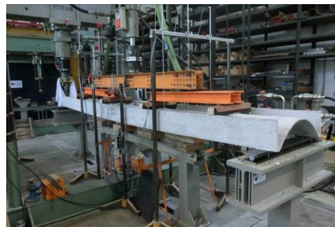
Abb.2 Prüfung eines Bauteiles mit 5,4 m Länge und nur 90 kg Gewicht; die eingebaute textile Bewehrung besteht aus Vliesstoff und Carbongitter
