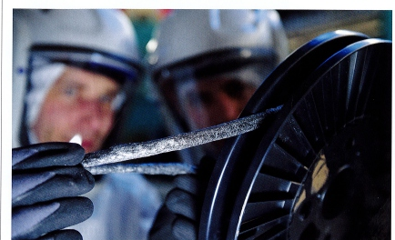
Stapellaserband auf Spule: Ronny Kuhn und Franz Günther prüfen im Sächsischen Textilforschungsinstitut unter Schutzbedingungen die Oberflächenqualität von Carbonlaser-Sekundärwindungen.
