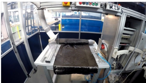
Versuchsaufbau zur Durchführung von Separationsversuchen
