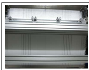
Abb. 2: Integration der Sensormaterialien in die textile Fläche mit Hilfe des Webens und Verbundwirkens
