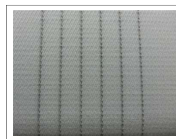
Abb. 2: Integration der Sensormaterialien in die textile Fläche mit Hilfe des Webens und Verbundwirkens
