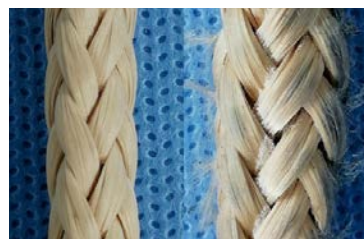
Probe Technora®, neu (links), belastet (rechts)
