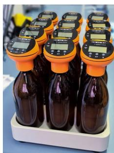
Prüfung der Bioabbaubarkeit mittels BSB-Messsystem OxiTop®-IDS
