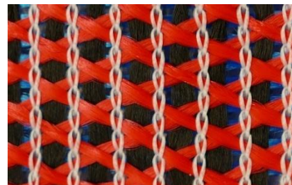
Abbildung 2: Wirkmuster mit maschenreihengerechten diagonalen Schussfadenverlauf
