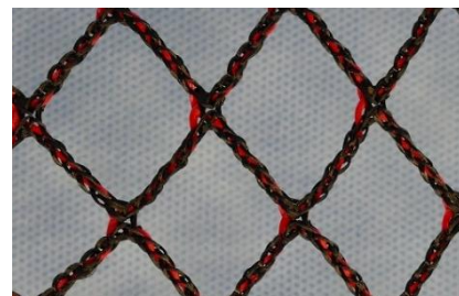
Abbildung 3: Gewirktes Netz mit lastpfadgerechten diagonalen Schussfadenverlauf
