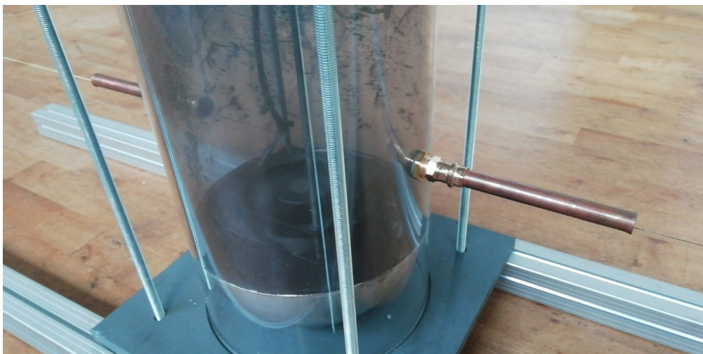
Versuchsstand einer Wirbelkammer zur homogenen Garnbeschichtung von Fasern und Garnen
