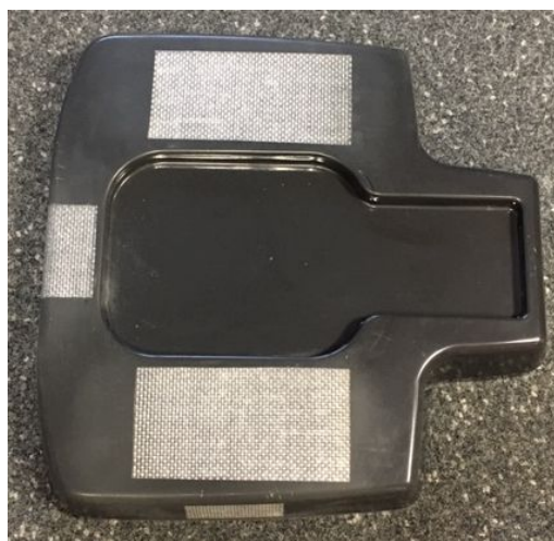
Abb. 2: Demonstrator-Bauteil aus GFK mit lokalen angeordneten thermoplastischen Basis-Flächen zum Schweißen (Werksfoto Lätzsch GmbH)
