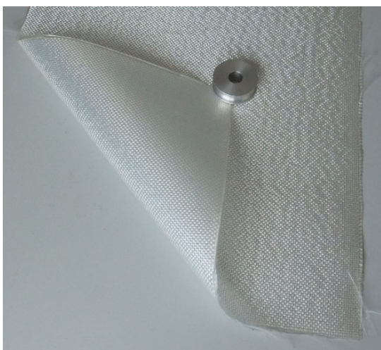
Abb. 1: Thermoplastisch teilkonsolidiertes Glasfaser-Gewebe
