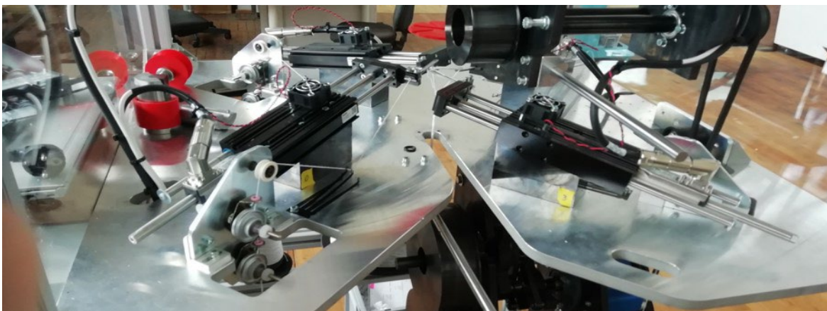
Abbildung: Versuchsstand der KEMAFIL®-Anlage mit Linearmotoren im STFI-Technikum
