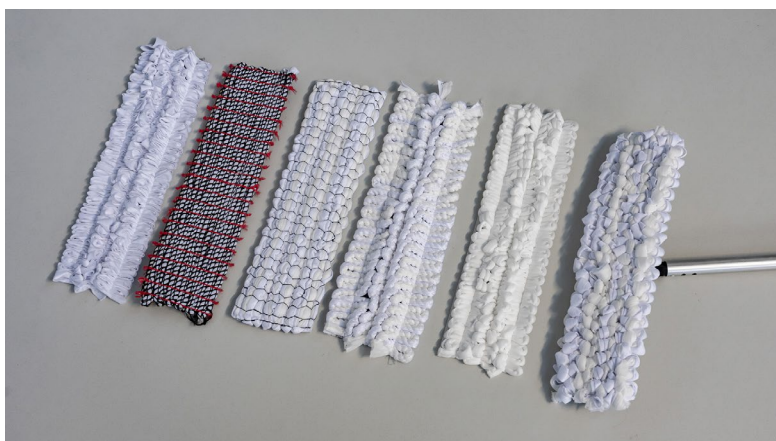
Variantenreich zum Ziel: Vom Randstreifen über den KEMAFIL®-Strang zur Fläche (Foto: STFI / Dirk Hanus)
