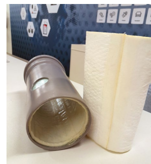
Schlauchliner eingehärtet, UV-gehärtet im defekten Abwasserrohr (l.), konfektioniert (r.)
