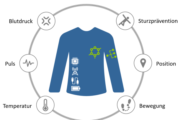
Prinzipiskizze: Sensorshirt mit den wesentlichen im Projekt zu untersuchenden Parametern (© MeDConNet. GmbH)
