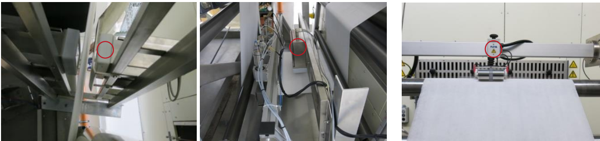
Mikrowellenfeuchtemessgerät zwischen AquaJet-Anlage und Ultraschallsystem (links) sowie zwischen Ultraschallsystem und Siebtrommeltrockner (rechts)
