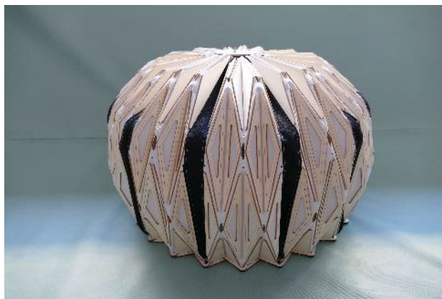
Holz-Textil-Faltwerk (HTF) | Copyright: STFI
