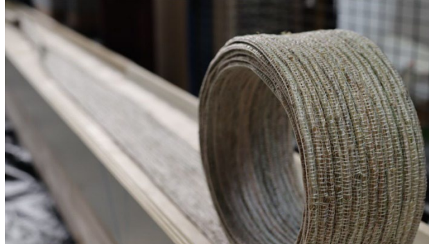
GROCOCE – Das neuartige Deckensystem besteht aus Holzstegen, deren Zugzone durch hochleistungsfähige, hanffaserbasierte Armierungstextilien verstärkt ist. | Copyright: HTWK
