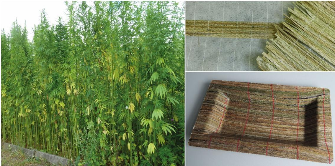
Hanfpflanzen (links) als Rohstoff für textile Halbzeuge aus schädigungsfrei isolierter Hanfbastrinde (rechts oben) werden zum Faserverbundbauteil.
