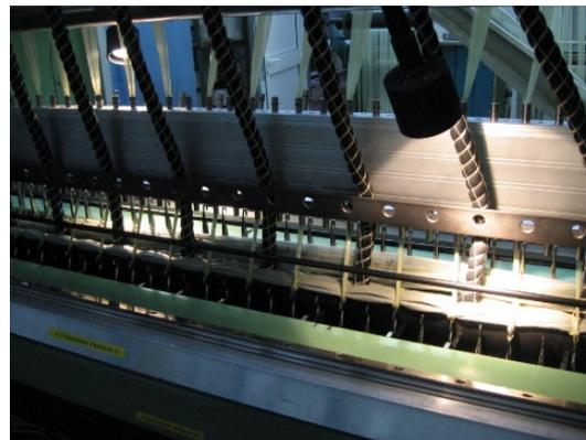
Abb. 1: Zuführung von gefassten Vliesstoffbändern in die Nadelgassen
