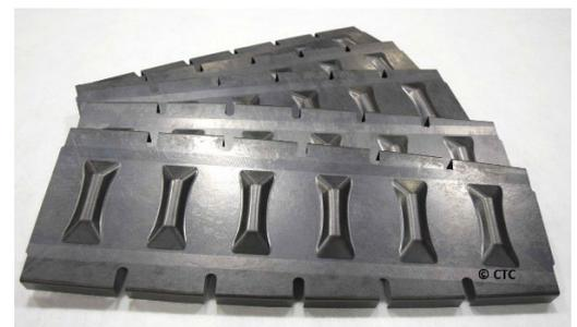
Airbus A320: lasttragende Rippe des Seitenleitwerks (VTP-Box)
