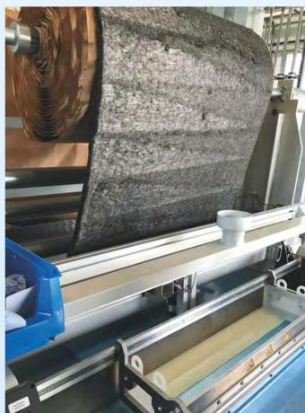
Abbildung 2: Zuführung des unverfestigten Vliesstoffes in die SMC-Anlage
