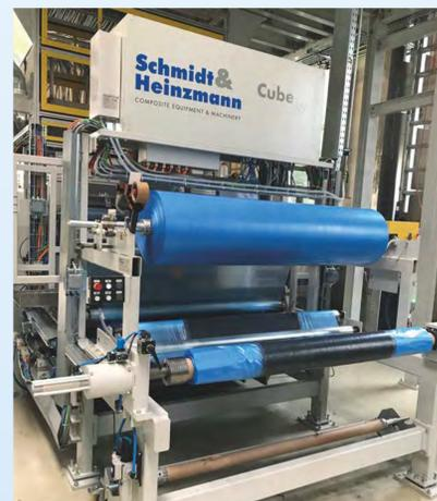
Abbildung 3: VliesSMC-Halbzeugherstellung am Fraunhofer ICT
