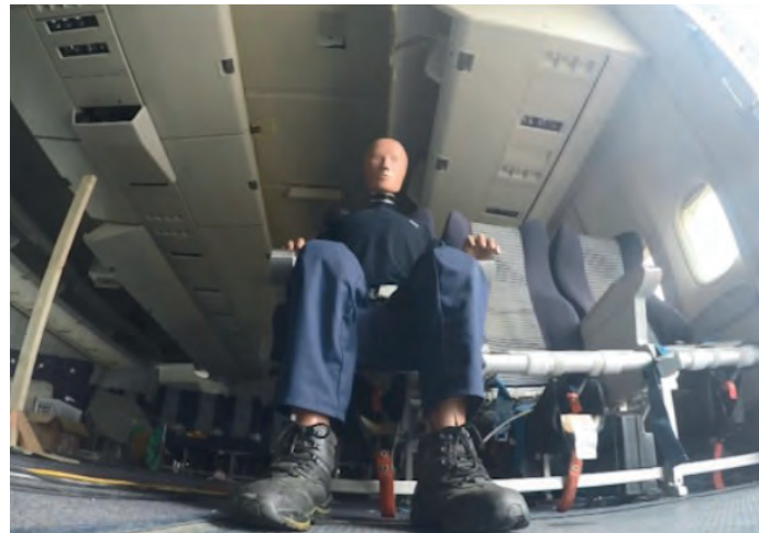
Sprengtest der ULD-AKE-Version des FLY-BAG im Frachtraum eines Großraumflugzeugs
