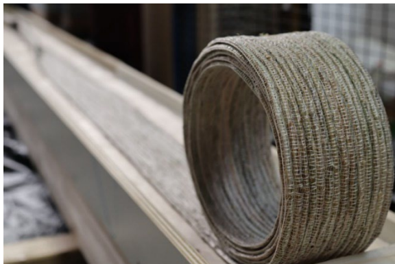
Abbildung 2 und 3: Applikation Hanfbastbänder am Holzbalken
