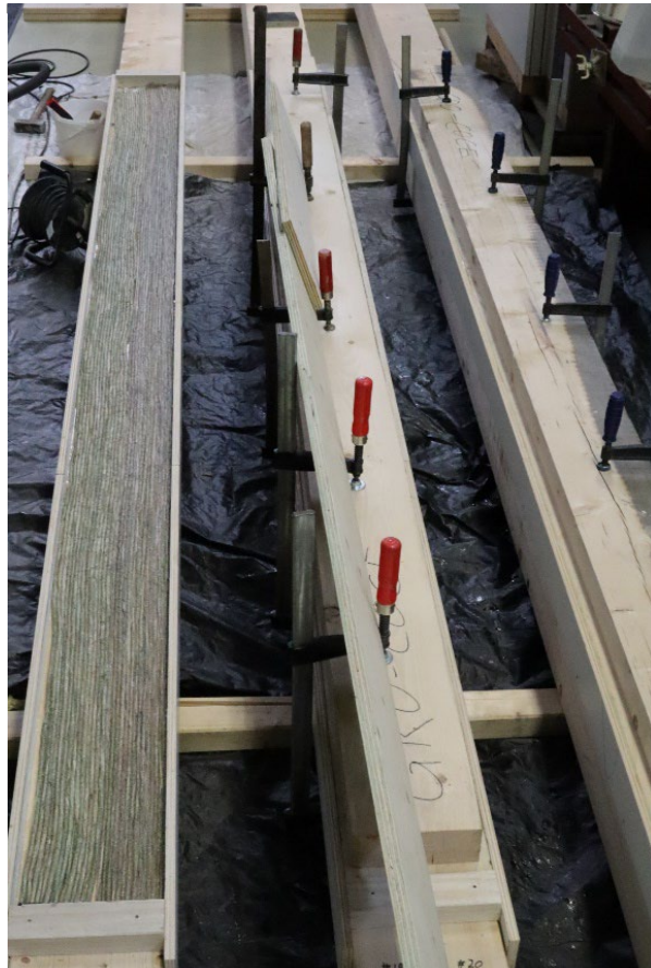
Abbildung 1: Geschälter manuell gebündelter Hanfbast
