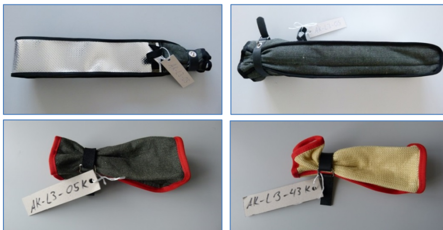
Abb.: Akku-Sicherheitstaschen – Demonstratoren für E-Bike-Akkus (oben) und Modellbau-Akkus (unten)
