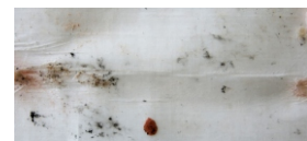
letzte Lage des Spezialtextils 2 zeigt keine Schädigung
