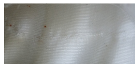
Fäden Spezialtextil 1 sind nur an wenigen Stellen angeschnitten bzw. leicht angedrückt
