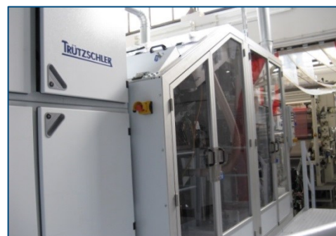
EWK-413 mit Kreppeleinspeisung (Trützschler Nonwovens GmbH)
