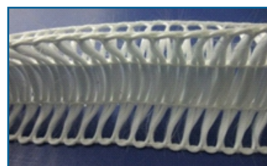
Bandförmige, gewirkte 3-D Bewehrungsstruktur aus Glasfaserrovingen
