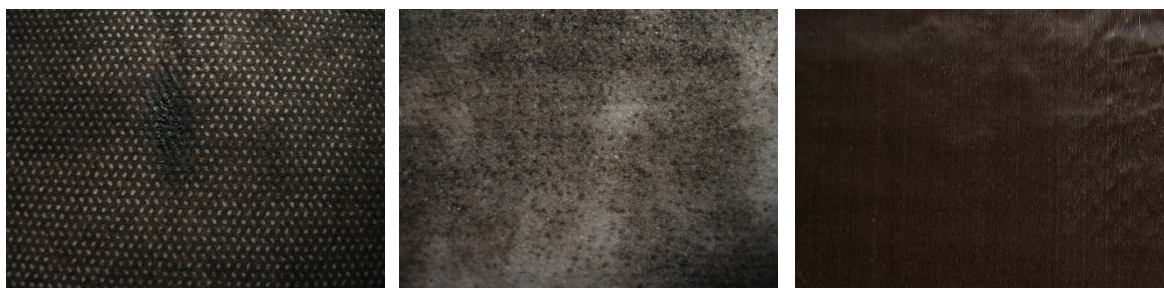
Beschichtete Vliesstoffproben (von links: Polyurethan-Streichbeschichtung, Polyacrylat-Tauchbeschichtung, Polypropylen-Hotmeltbeschichtung)
