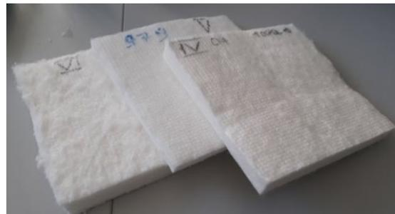
Abb.: Voluminöse Vliesstoffe mit hoher Schallabsorptionsfähigkeit im breitbandigen Frequenzbereich
