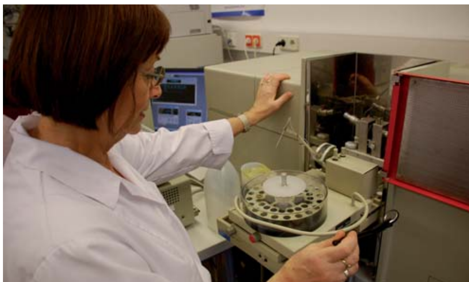
Am Atomabsorptions-Spektrometer prüft Chemielaborantin Petra Scherf textile Materialien hinsichtlich ihres Gehalts von Schwermetallen wie Blei und Kadmium.
