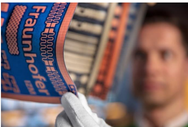
Textile Leiterplatte des Projekts TexPCB, Quelle: Fraunhofer IZM, Volker Mai
