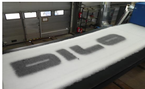
Schriftzug mit partiell zusätzlichem Fasermaterial, Quelle: Oskar Dilo Maschinenbau KG
