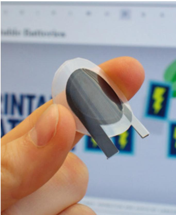
Gedruckte primäre Batterie auf flexibler Folie, © Professur Digitale Drucktechnologie und Bebilderungstechnik, TU Chemnitz
