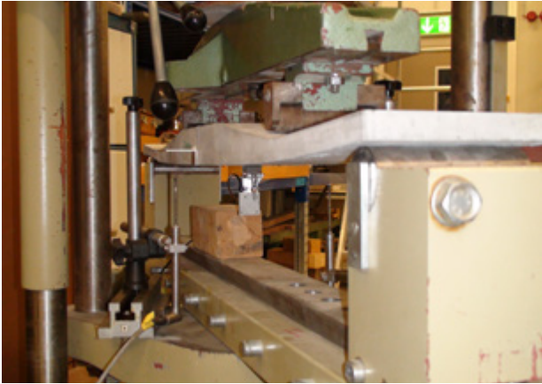
Abbildung 5: Ein Schalenmodell für Vergleichsrechnungen für einen Betonbogen mit isolierter Biegebeanspruchung wurde aufgebaut. Die erfolgreiche Verifikation der zugehörigen Messwerte erfolgte dabei ohne Verwendung und zusätzliches Kalibrieren von Parametern aus den Zug- und Druckproben der vorangegangenen Prüfungen. Foto: IfB, TUD
