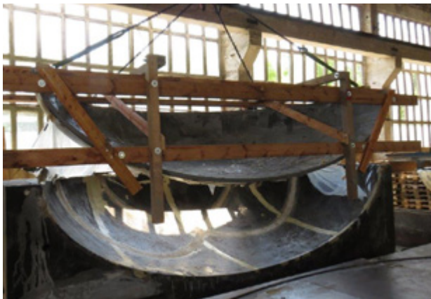
Abbildung 8: Die Herstellung des Demonstrators erfolgte in einer 3D-gefrästen Schalung aus verfestigtem Gießsand. Die Entformung erfolgte nach einem mehrtägigen Trocknungsprozess. Foto: BCS Natur- und Spezialbaustoffe GmbH
