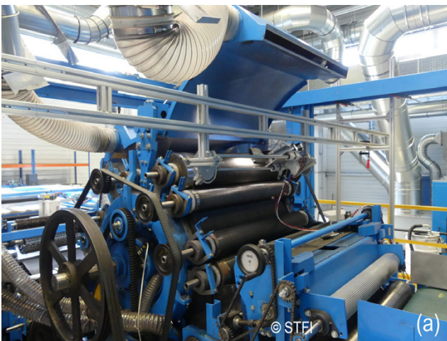
Abbildung 5: Messaufbau an Arbeiter 2 der Technikumskrempel – Übersicht (a) und Detail (b), Quelle: STFI
