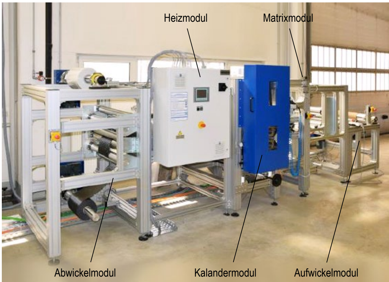
Abbildung 4: Versuchsanlage zur Herstellung teilkonsolidierter thermoplastischer Halbzeuge und matrixhybrider Prepregs, Quelle: Cetex Institut für Textil- und Verarbeitungsmaschinen gGmbH
