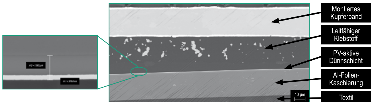
Abbildung 10: Querschliffe von Metallfolien-kaschierten PhotoTex Komplettsystemen. Links: Detailausschnitt der Dünnschichtabscheidung auf Folienkaschierung. Rechts: Querschnitt des Gesamtsystems. Quelle: Fraunhofer IKTS
