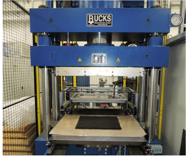
Abbildung 13: Verarbeitung des rCF-Prepregs mittels hydraulischer Oberkolbenpresse am STFI. Quelle: STFI
