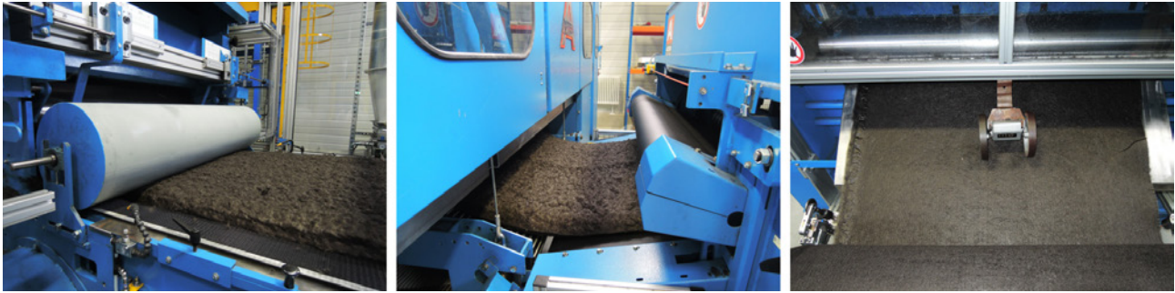
Abbildung 6: Airlayverfahren und Vernetzung am STFI. Quelle: STFI
