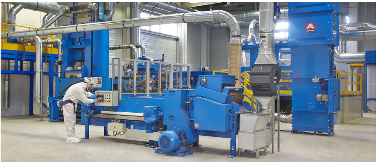
Abbildung 3: Carbonvliesstoffanlage am STFI. Quelle: STFI
