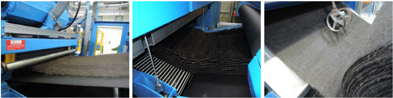
Abbildung 7: Vliesstoffbildung mittels Krempel, Kreuzleger und Nadelmaschine am STFI. Quelle: STFI
