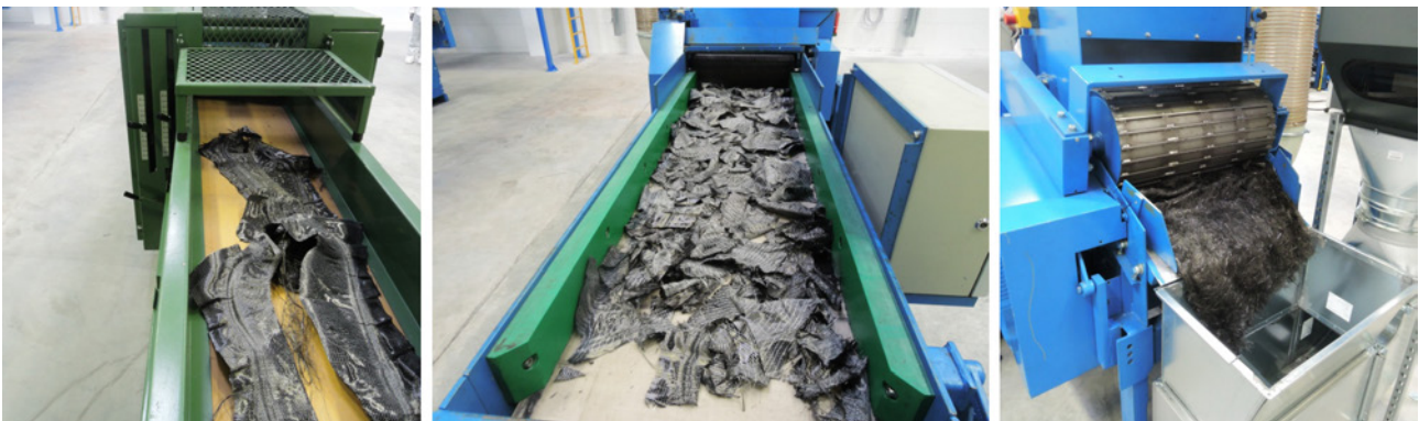
Abbildung 5: Faseraufbereitung mittels Schneid- und Reißmaschine am STFI. Quelle: STFI
