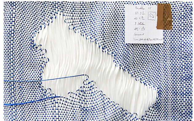
Abbildung 4: Muster eines endkonturnahen Gewebes. Quelle: ITM
