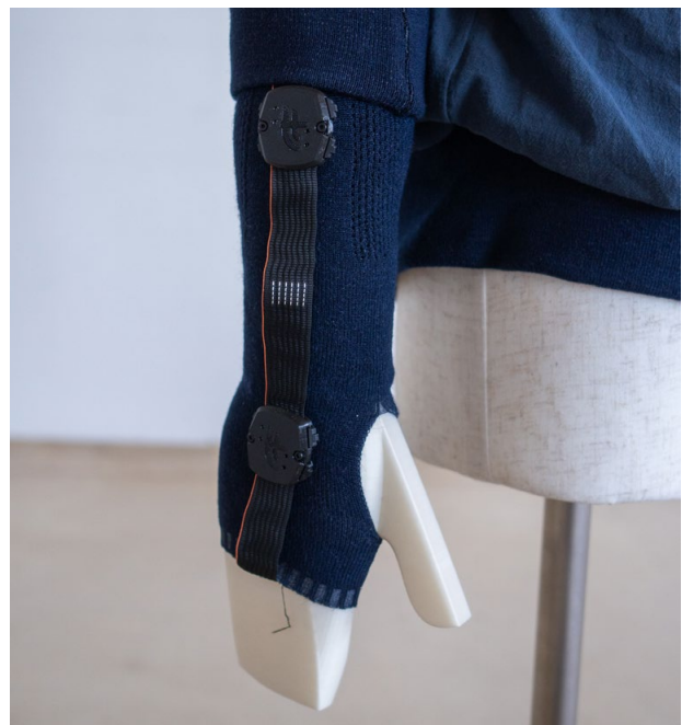
Abbildung 6: Ärmелеlement mit integrierter verkapselter Elektronik (SmartIMUs), Quelle: TU Berlin
