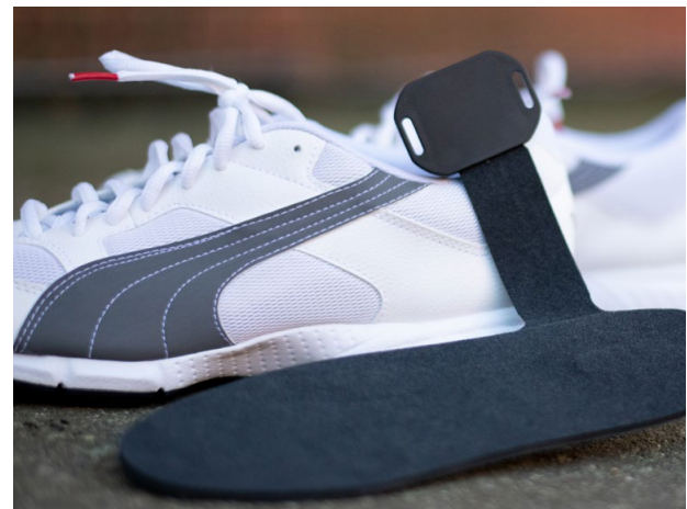
Abbildung 8: Schuhsohle mit integrierten Drucksensoren, Quelle: Fraunhofer ISC
