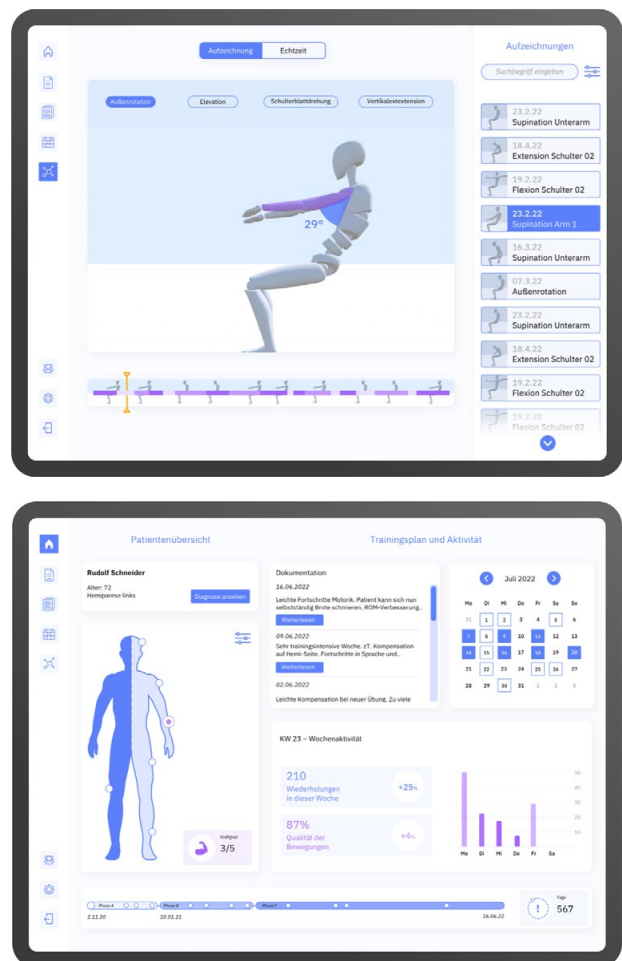
Abbildung 10: Interface entwickelt für Therapeut*innen, oben: Darstellung von Trainingssessions in Echtzeit, unten: Überblick über die wichtigsten Trainingsdaten zur Auswertung, Quelle: ART+COM
