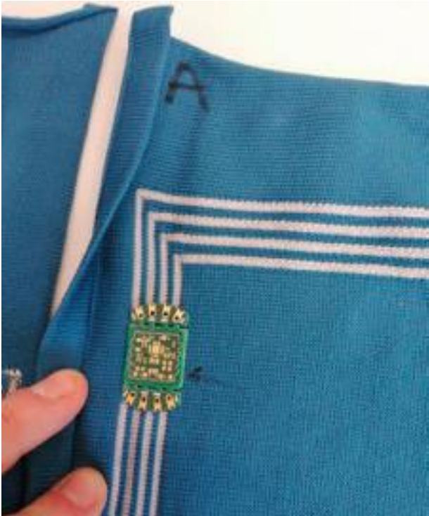
Abbildung 4: Busstruktur mit gebondeter Leiterplatte, Quelle: Strick Zella
