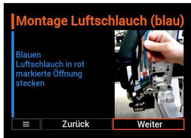
Abbildung 16: Ansicht der Luftschlauchmontage im Assistenzsystem, Quelle: STFI
