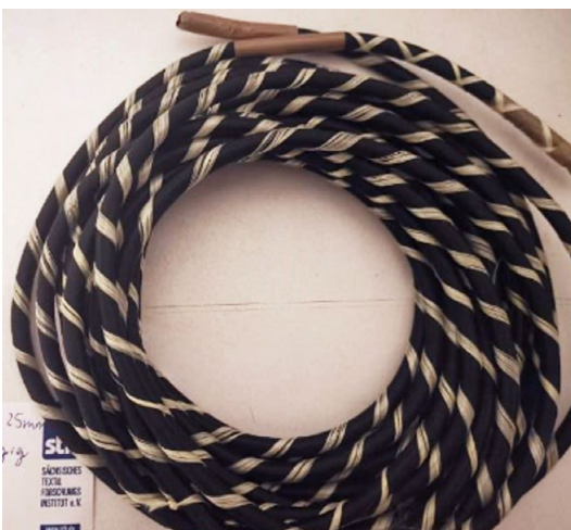
Abbildung 2: Materialprobe mit einem Umwindegarn (links), Vorzugsvariante: Überprüfung der Wirkung des auxetischen Effektes – deutliche Volumenzunahme des Dichtbandes (rechts), Quelle: Stefan Käseberg
