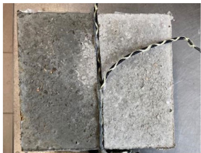
Abbildung 3: Fugendichtung ohne auxetischer Wirkung – rechte Betonseite wird ebenfalls durchfeuchtet (links), Fugendichtung mit auxetischer Wirkung – rechte Betonseite bleibt trocken (rechts), Quelle: Stefan Käseberg
