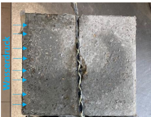
Abbildung 3: Fugendichtung ohne auxetischer Wirkung – rechte Betonseite wird ebenfalls durchfeuchtet (links), Fugendichtung mit auxetischer Wirkung – rechte Betonseite bleibt trocken (rechts), Quelle: Stefan Käseberg
