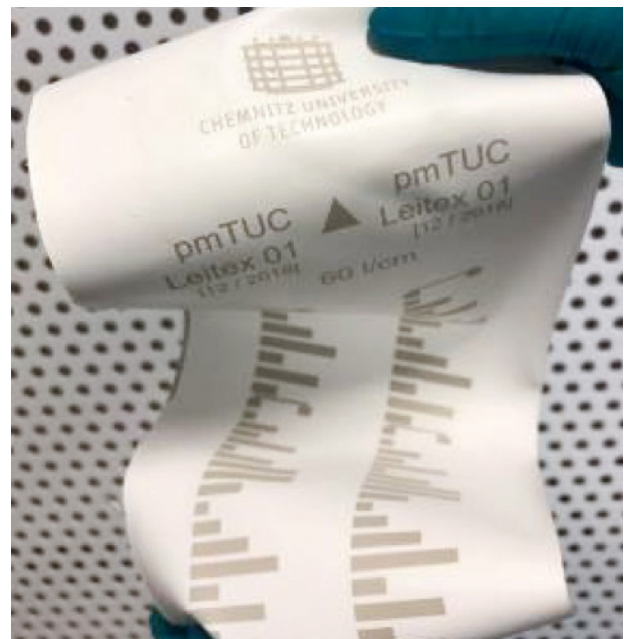
Abbildung 1: Im Tiefdruck gedruckte, flexible, kapazitive Elemente und Leitbahnen auf Hygienetextil. Quelle: Technische Universität Chemnitz
