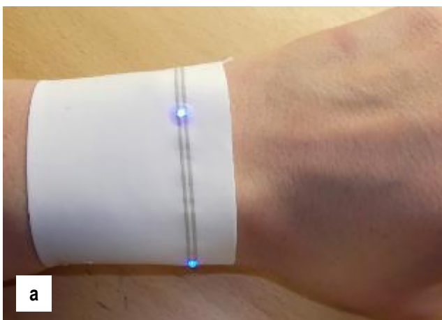
Abbildung 8: a) gedruckte flexible Silberleitbahnen auf Hygienetextil, versehen mit LED und Energiequelle. b) Batteriedemonstrator auf technischem Textil. Quelle: ENAS
