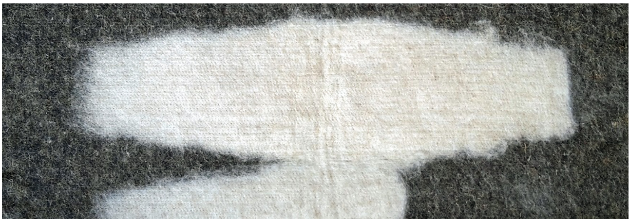
Abbildung 3: topologisch optimierte Naturfaser-Halbzeugvariante. Quelle: optiformTEX
